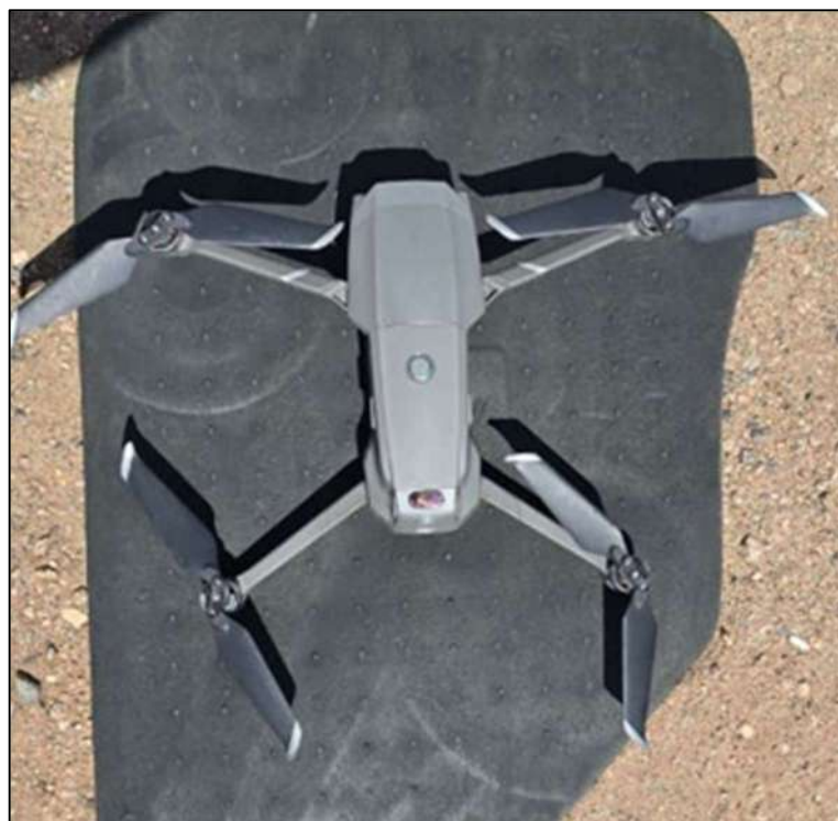
Figura 7 – Veículo Aéreo Não Tripulado usado na aerofotogrametria
